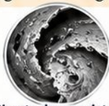
Girante danneggiata da cavitazione
