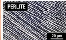
Struttura lamellare di ferrite e cementite.
